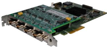
La carte iSAFT SpW est la solution SpaceWire la plus avancée sur le marché spatial. Interface PCIe haut de gamme, elle prend en charge 4 ou 8 ports SpW. Ces cartes permettent, entre autres, la transmission asynchrone, la génération de trafic, l'enregistrement de paquets, la précision d'horodatage, le débit de données élevé et la synchronisation avec IRIG-B.
