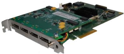
Dernière-née chez TELETEL, la carte iSAFT SpFi est une interface PCIe avancée basée sur un codec SpaceFibre éprouvé dans le secteur. Capitalisant sur le succès d'iSAFT SpW, cette carte permet également la transmission asynchrone, la génération de trafic, l'enregistrement de paquets, la précision d'horodatage élevée, la synchronisation avec IRIG-B, etc.
