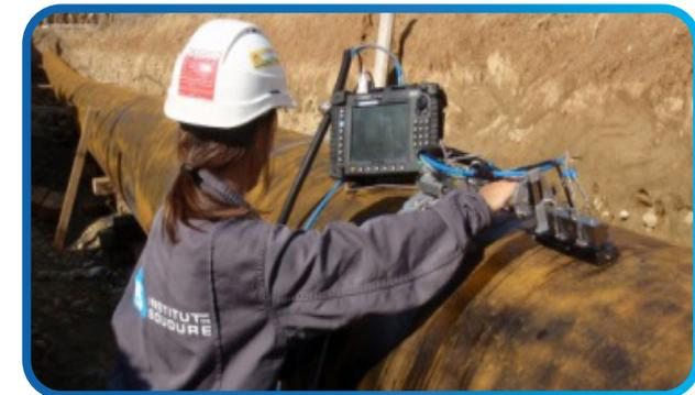
**L'agent de contrôle non destructif** est le garant de la conformité des infrastructures soudées ou sous pression. Il prépare et organise des contrôles en ateliers lors de la fabrication de nouveaux éléments ou sur sites industriels lors des arrêts de maintenance. Ce métier ne connaît pas la crise tant les opportunités sont grandes en France comme à l'International.
