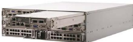
Le nouveau serveur XR6 RES HD est équipé des derniers processeurs Intel® Xeon® Scalable et de trois modules supplémentaires de stockage, d'une extension PCIe et de switches managés. Composé de produits sur étagère et branché sur trois châssis extensibles, le module RES HD offre des performances et des capacités additionnelles sans que les utilisateurs aient à remplacer leurs systèmes existants.
