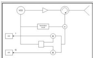
Figure 3 : Synoptique radar
