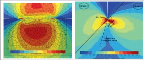
*Modèle polycristallin de propagation de fissures de fretting : modélisation par éléments finis de la propagation de fissures de fretting sur agrégat polycristallin afin de prendre en compte la variabilité du comportement du matériau*
