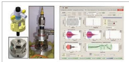
Figure : banc low cost de caractérisation directe à haute fréquence de matériaux
